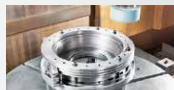
ブレーキリング端面及び内外径の研磨
